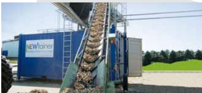
Séchoir WT 0.5 en fonctionnement : séchage de copeaux de bois
